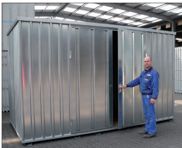
Container, 2300 x 2400 x 4100 mm (B x H x T), mit besonders breiter Tür in der Längsseite (1950x1890mm).
